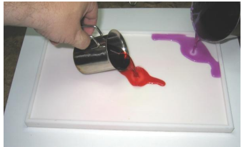
Abb. 5.2: Mit zwei oder mehreren Gießgefäßen werden nun die Wachse in die Form gegossen.
